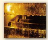
エレメントの表面温度は、内部の水温に 対して10℃から20℃程度高くなります。 従って、表面には結露した強酸性水が付 着し、エレメントを腐食させる原因となり ます。
